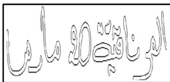
b- Extraction du contour par la méthode de Canny
